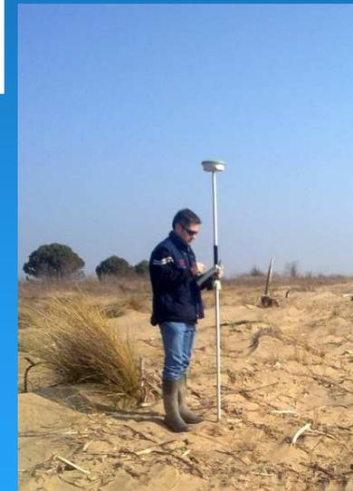
Perimetrazione delle aree afferenti ai singoli tratti di canali o collettori di scolo con definizione dei principali parametri idraulici. Valutazione della tessitura dei terreni tramite carte litologiche e geopedologiche.
