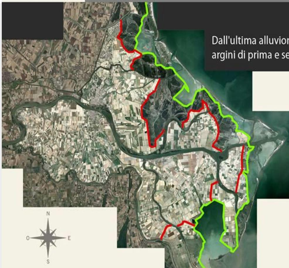
Dall'ultima alluvione da mare del 1966 sono stati realizzati argini di prima e seconda linea di difesa a mare
